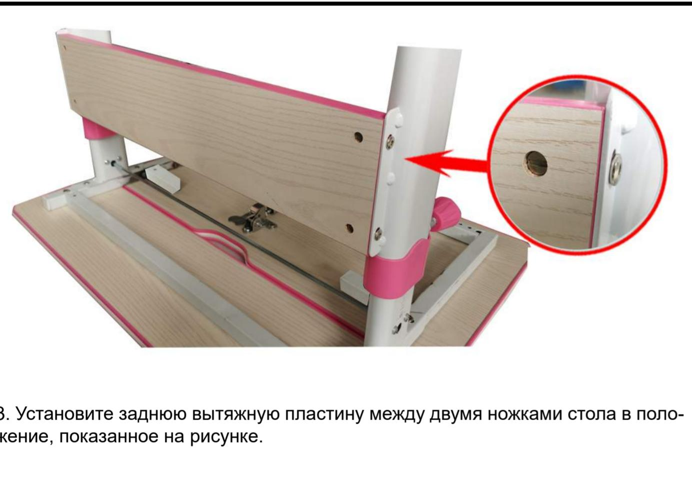
3. Установите заднюю вытяжную пластину между двумя ножками стола в положение, показанное на рисунке.
